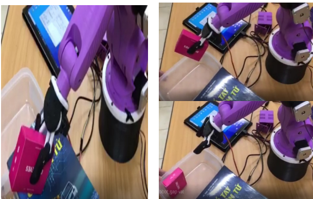
Hình 7. Robot gấp vật từ vị trí thứ nhất đến vị trí thứ hai
